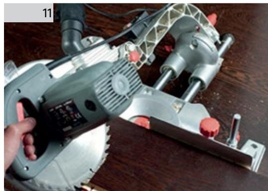
Внешний угол отделываем, например, срезая края досок под углом 45 градусов. На стыке краев наносим монтажный клей.
